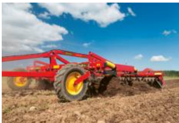
De Cultus 300-400 kan zowel in getrokken als in gedragen uitvoering worden geleverd.
