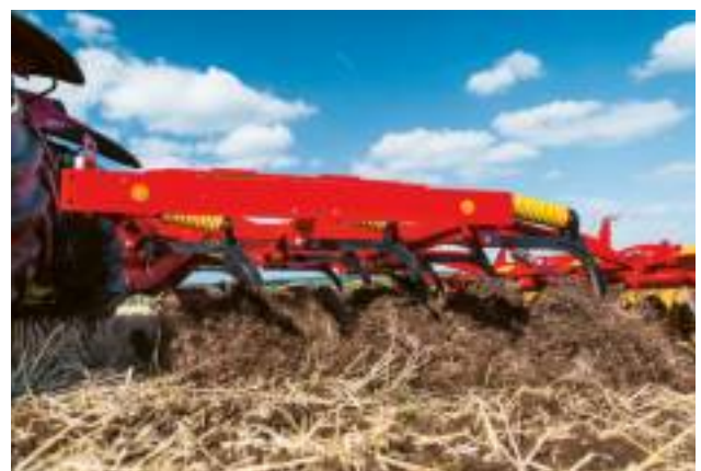
Cultus-tanden gaan tot een diepte van 25 cm en leveren uitstekende kwaliteit.
